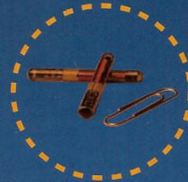
La technologie RFID sans fil, sécurisée et intelligente représente une nouvelle ère d'identification de véhicule. Les transpondeurs miniaturisés NANO-TAG vont changer la manière dont les véhicules sont identifiés. Ils servent à identifier électroniquement et à distance les véhicules ainsi que les composantes auxquelles ils sont fixés. Ils permettent de renforcer encore davantage l'aspect préventif du vol de véhicule.
